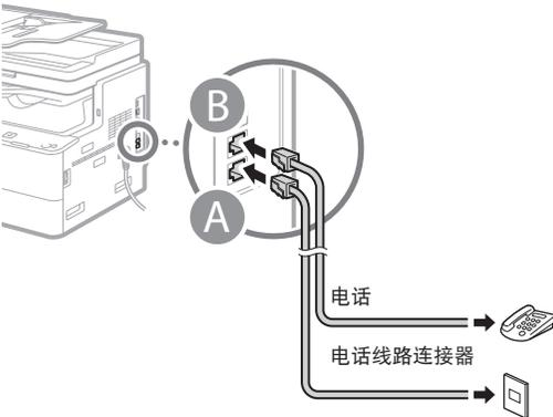
显示屏上出现 <连接电话线路> 时，请参照图例连接电话线。
